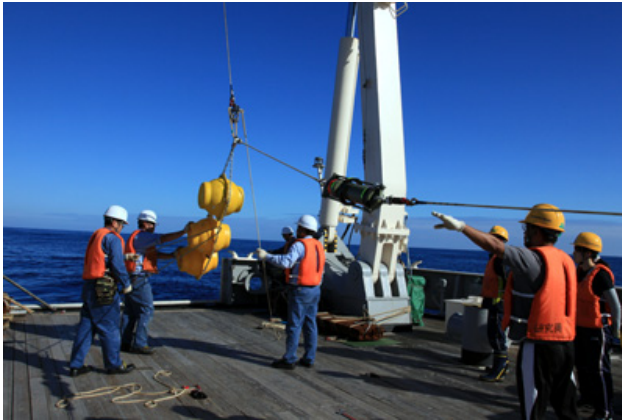
流向流速計の設置作業
