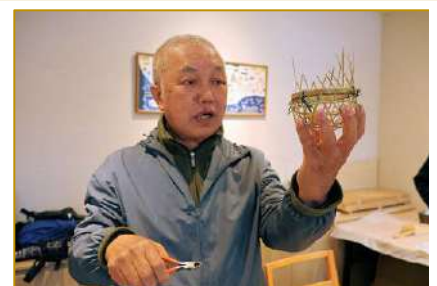
⑨籠に縁を付け、余分な竹ひごをカットします。
