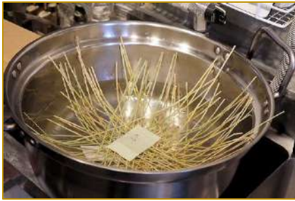
④編んだ竹ひごを水に浸けて柔らかくします。
