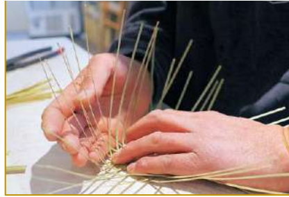
⑤底の部分を押さえて、優しく優しく竹ひごを立ち上げていきます。
